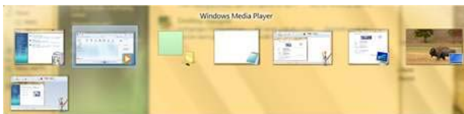
Obr 4: Ve Windows 7 Ultimate vidíte při přepínání pomocí kláves ATL+Tab malé náhledy obsahu spuštěných aplikací, Starter (na obrázku dole) toto nenabízí.
