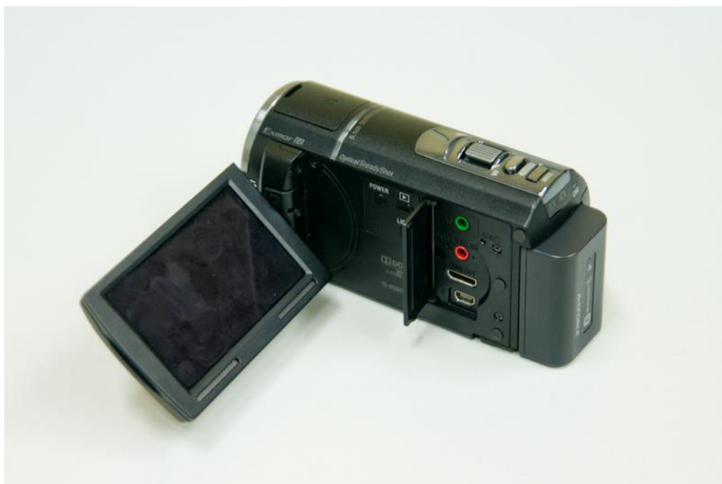
Obr. 22: Sony HDR-CX570EB má zabudovaný vstup pro mikrofon
